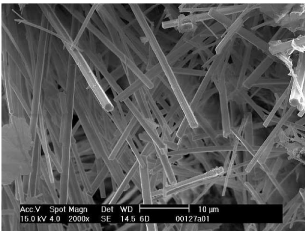
Fig. 9. SEM picture of the ettringite in the mortar (case study 2).
