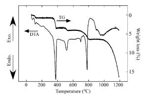
Fig. 1. DTA-TG curves of BLT-NaCl.
